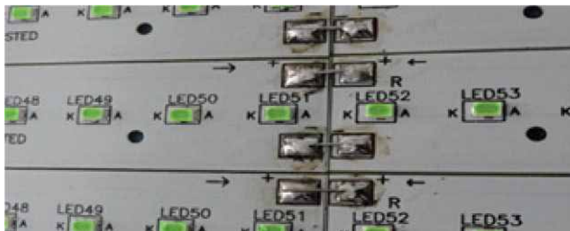
चित्र 2.1.12: जम्पर वायर के साथ दो हल्के इंजनों को मिलाया।
